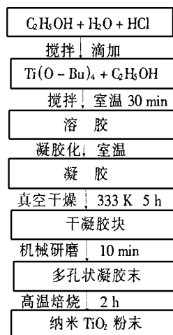
图1 由钛酸丁酯 [Ti(O-Bu)_4] Sol-gel法合成纳米二氧化钛流程
